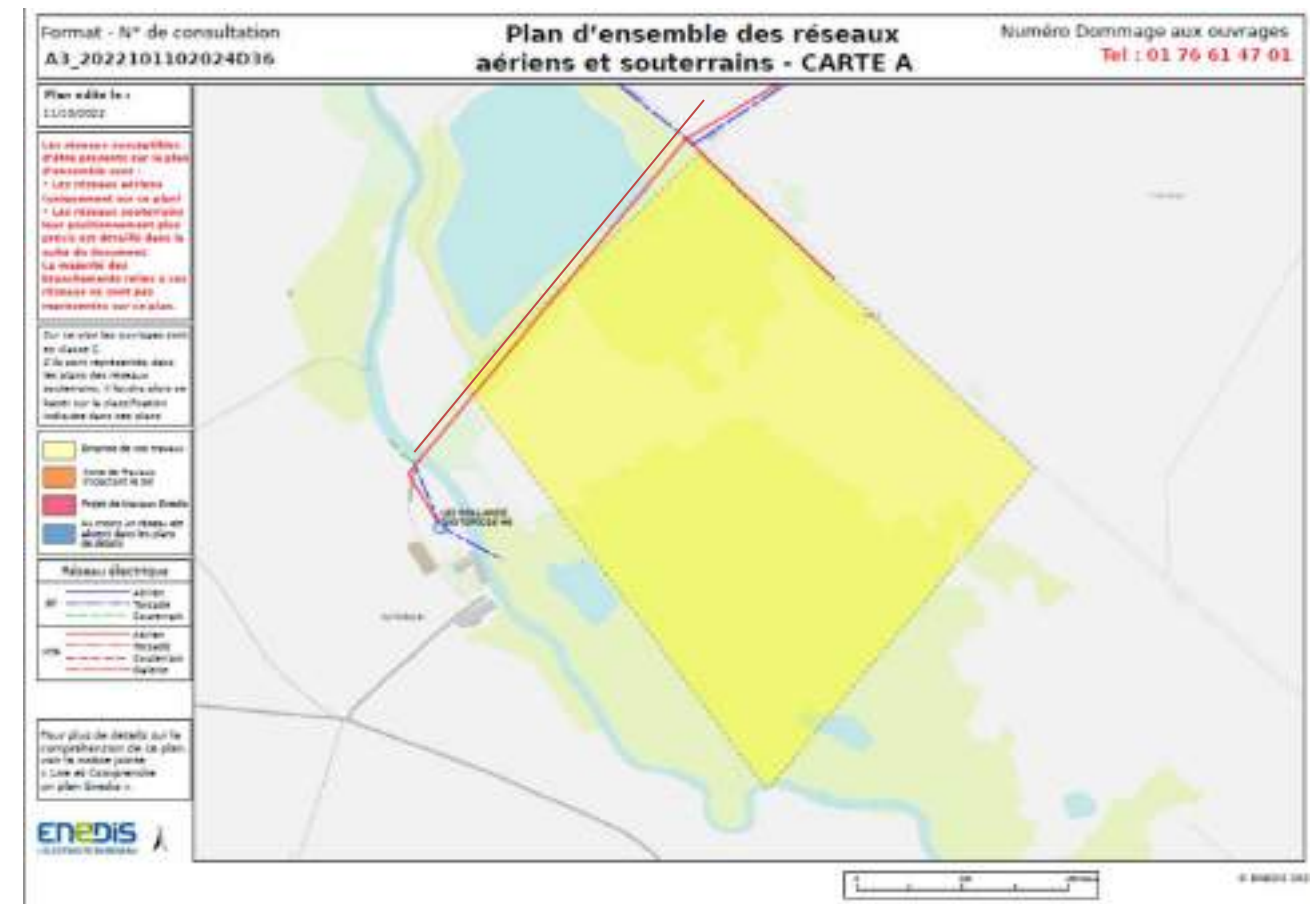
Carte 78 : Tracé de la ligne électrique ENEDIS traversant une partie du Nord-Ouest de l'aire d'étude immédiate
